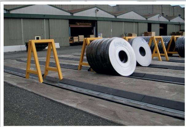
Zur Fixierung müssen die KLP® Coilwedges in Stahlrahmen gelegt werden.
