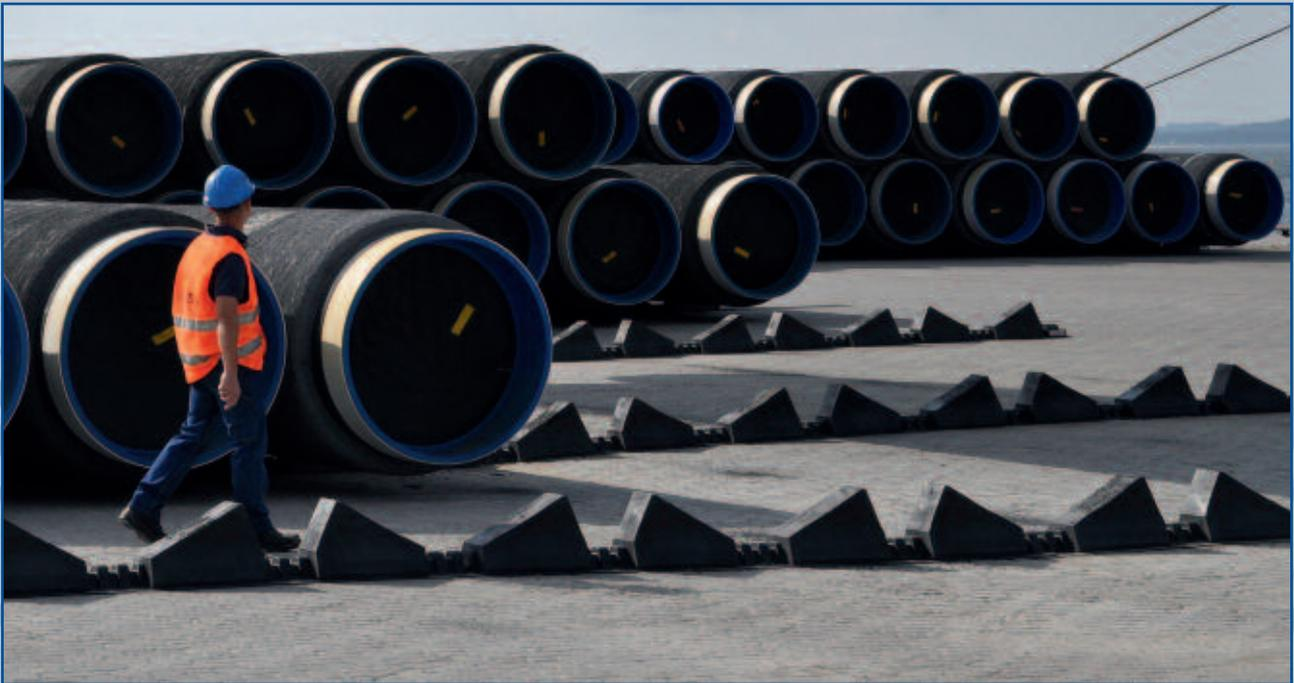
Die Rohre können bis zu 20 Schichten hoch gelagert werden, je nach Gewicht und Anzahl der Schienen. Für Ihre spezifische Situation bieten wir detaillierte Anweisungen und Stapelkonfigurationen.
